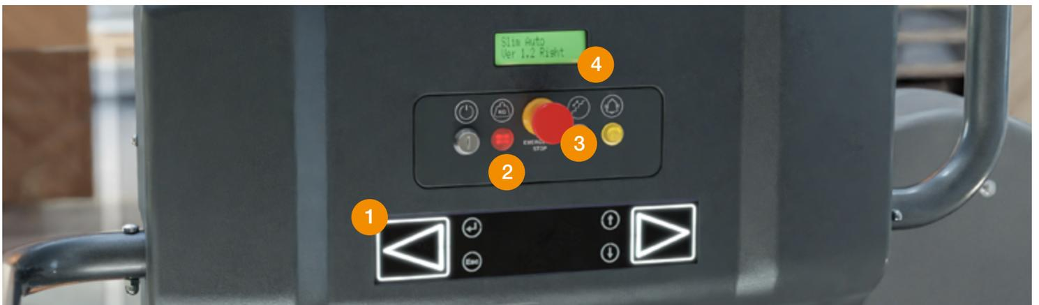
1. La **pulsantiera Touch** permette, una volta a bordo, la movimentazione ergonomica della piattaforma appoggiando semplicemente le dita o la mano sulle frecce luminose di salita/discesa, senza necessità di esercitare pressione su esse.
